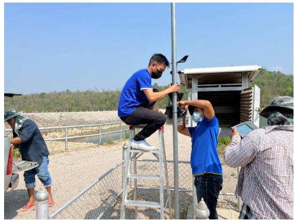
รูปที่ 5.2.1 – 10 การตรวจสอบเครื่องวัดปริมาณน้ำฝน
