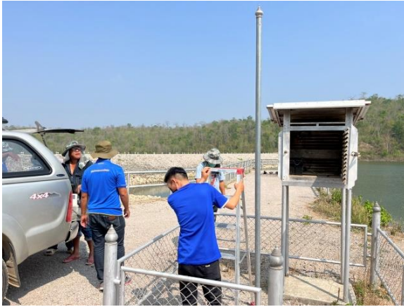
รูปที่ 5.2.1 – 10 การตรวจสอบเครื่องวัดปริมาณน้ำฝน
