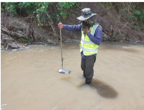
รูปที่ 5.2.1 – 12 การสำรวจข้อมูลอุทกวิทยา (ตะกอนแขวนลอย)
